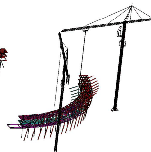
图 12-5-10 吊装南侧 XGZ2
