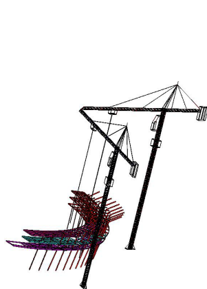
图 12-5-9 吊装北侧 XGZ2
