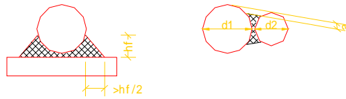
图 4.7.6 圆钢与钢板、圆钢与圆钢的连接焊缝
