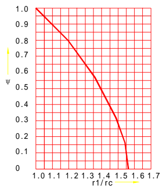
图 6.3.2—3 环形基础底板外形系数 \psi 曲线
